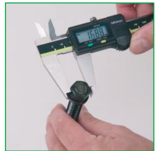
d Misurare l'esagono della testa della vite.
