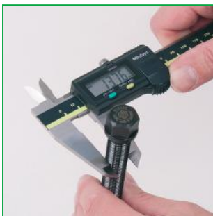
a Misurare il diametro della vite.
