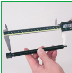
b Misurare la lunghezza del filetto della punta della vite.
