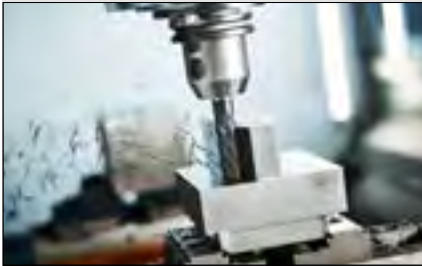
Fresatura di spallamenti
